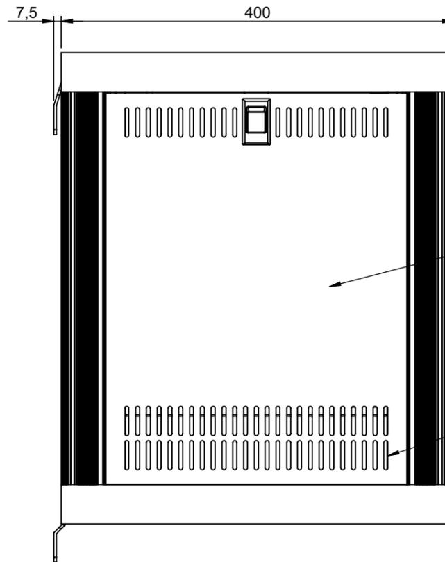
Puertas laterales desmontables con tirador deslizable.
