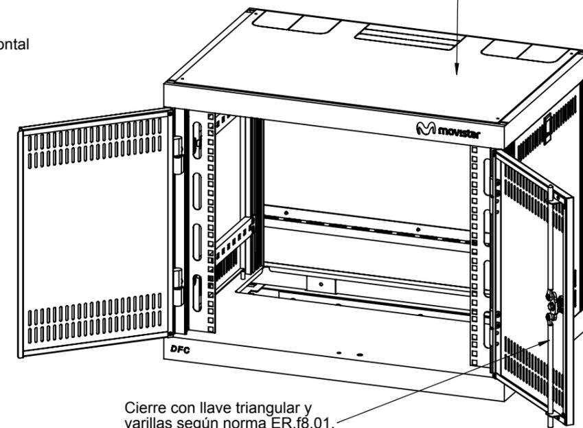
Cierre con llave triangular y varillas según norma ER.f8.01.
