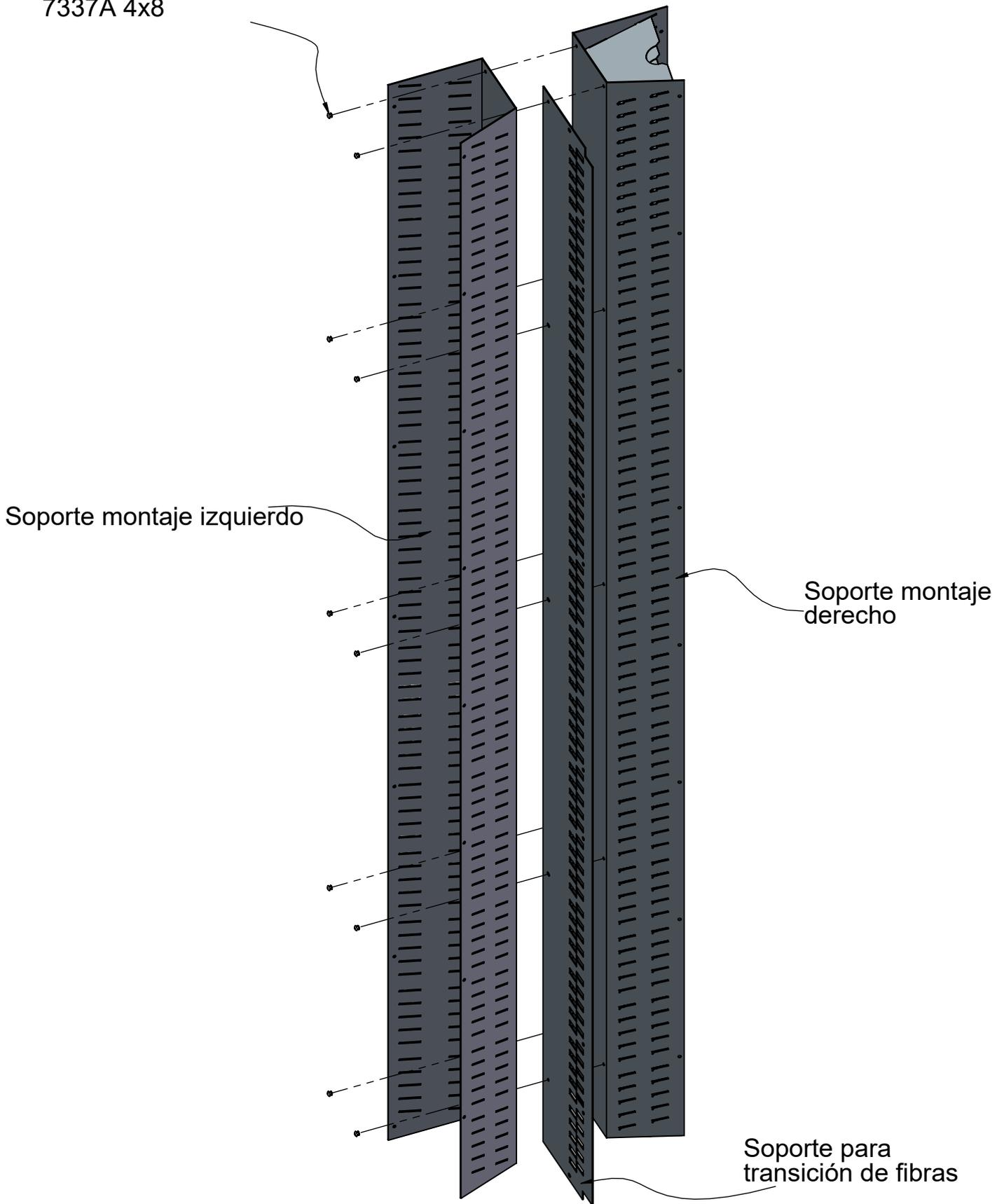
Uniremos las 3 piezas mediante remaches, posteriormente fijaremos el resto de bandejas para el lado izquierdo de la misma manera que las del lado derecho.
