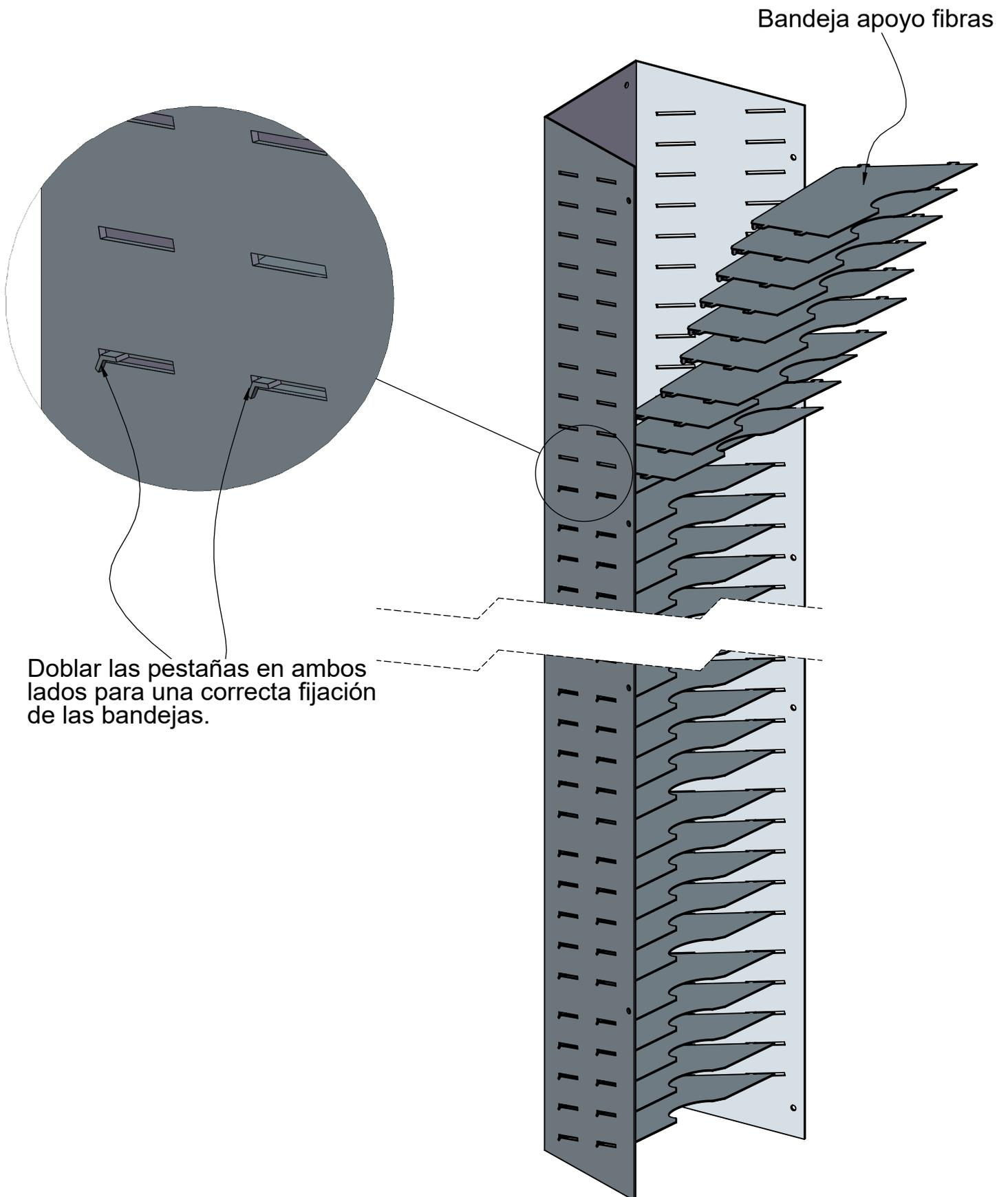
**IMPORTANTE:** Este ensamblaje debe realizarse antes de pintar las piezas para no tener problemas con el grosor de la pintura a la hora de insertar las bandejas. Tener en cuenta a la hora de colocar las bandejas, debemos asegurarnos de que esta haciendo tope con el fondo, y luego doblar las pestañas.
