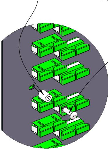
En total son 8 casquillos y 8 remaches de 4x18, hay que posicionar correctamente la pieza frontal con las etiquetas y remachar a la pieza
