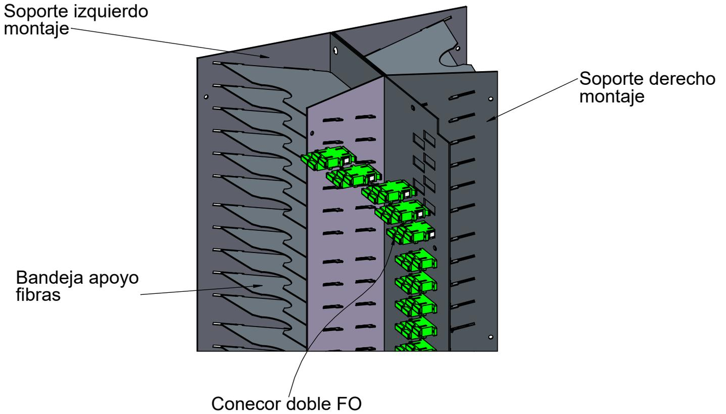
Fijar los 150 conectores en toda la pieza de soporte para la transición de fibras.
